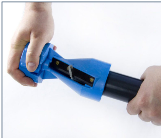
Fazowanie zewnętrznej krawędzi rury
