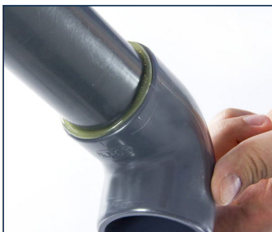
Prawidłowo wykonane połączenie klejone.
