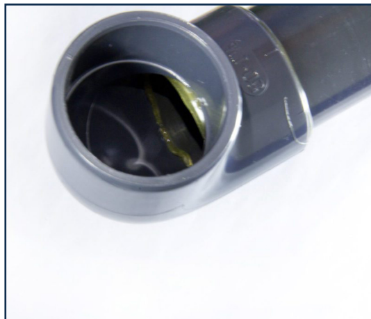
Prawidłowo wykonane połączenie klejone.
