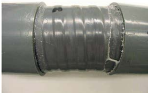
Uszkodzone złącze wykonane z użyciem tradycyjnego kleju rozpuszczalnikowego.
