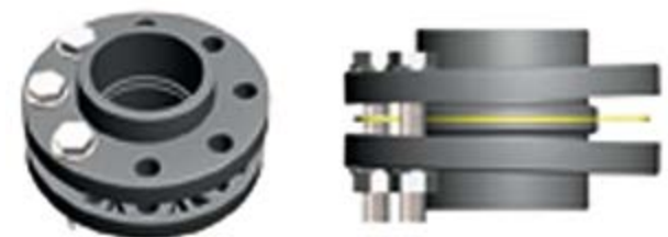
Nieprawidłowy sposób postępowania przy montażu.
